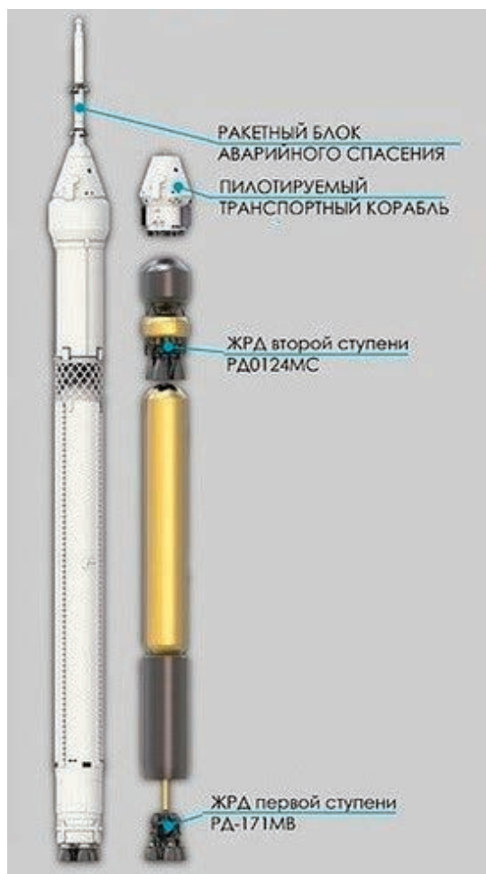
Рис. 2. Конструктивно-компоновочная схема РН «Союз-5»
