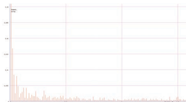
Рис. 6. Фурье преобразование первого этапа испытания (диапазон частот подшипника)
