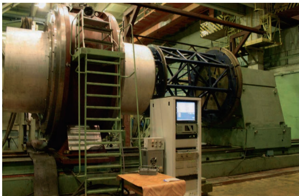
Рис. 6. Общий вид модуля для ЭЛС в локальном вакууме обечаек диаметром 2500 мм в цехе завода-изготовителя изделий
