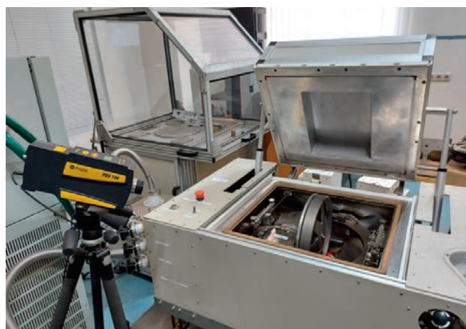
Рис. 1. Стенд контроля осевой нагрузки СКОН с двигателем-маховиком ДМ-001-01
