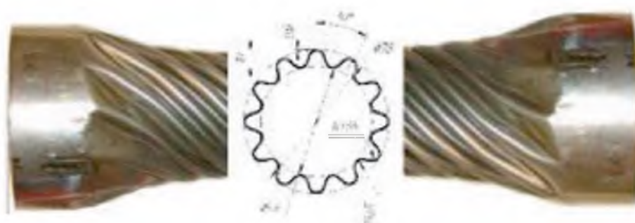
Рис. 4. Технологическая схема формирования геликоидного сиффона
