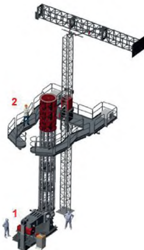
Рис. 2. Общий вид рабочего места проведения работ: 1 – стенд МЦМ15000; 2 – колонна с подвижной площадкой (ярусом) обслуживания
