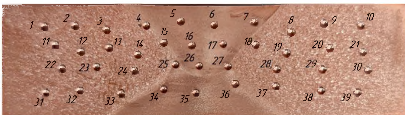
Рис. 4. Схема исследования твердости образца после двусторонней СТП
