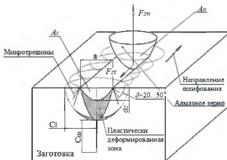
Рис. 4. Схема взаимодействия алмазного зерна и материала
