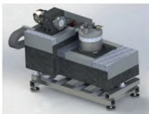
Рис. 2. Специальный ультрапрецизионный стенд для алмазного точения деталей из хрупких материалов
