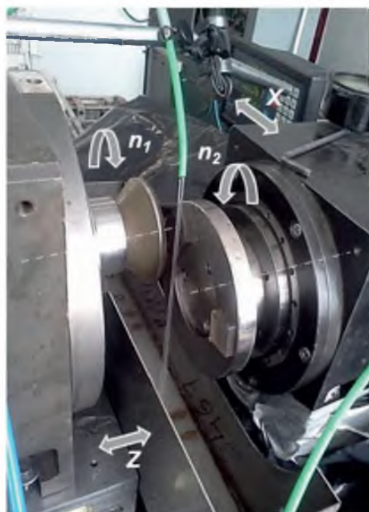
Рис. 5. Зона шлифования образца из ситалла СО115М на сверхточном экспериментальном стенде
