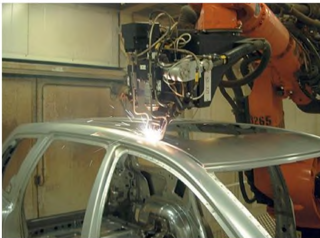
Рис. 1. Роботизированная лазерная сварка кузова автомобиля
