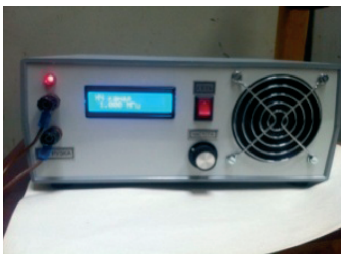
Рис. 1. Ультразвуковой генератор УЗГ1–0,01/950 в работе, подключенный к вакуумной индукционной установке «Кристаллизатор-105» (АО «Композит»), во время вакуумной плавки
