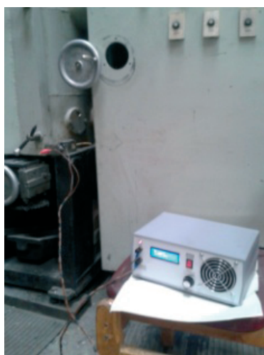
Рис. 1. Ультразвуковой генератор УЗГ1–0,01/950 в работе, подключенный к вакуумной индукционной установке «Кристаллизатор-105» (АО «Композит»), во время вакуумной плавки
