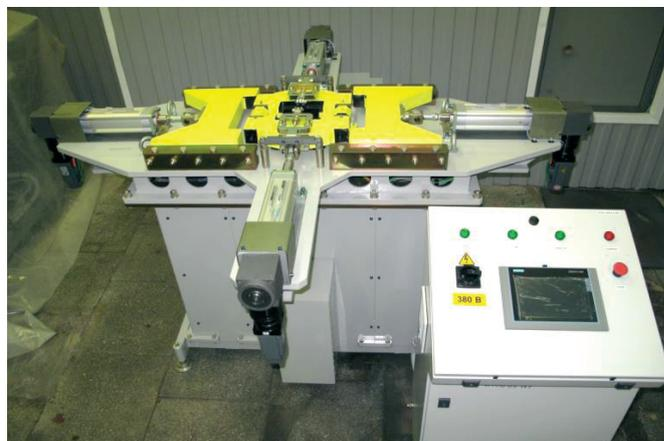
Рис. 3. Установка гофрирования ГВС сечением WR51-WR340
