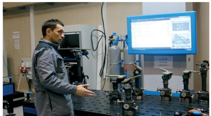
Рис. 3. Рабочее место сборщика трубопроводов по 3D модели
