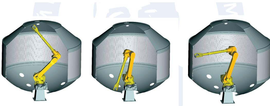
Рис. 16. Финишная очистка криогенного бака РН
