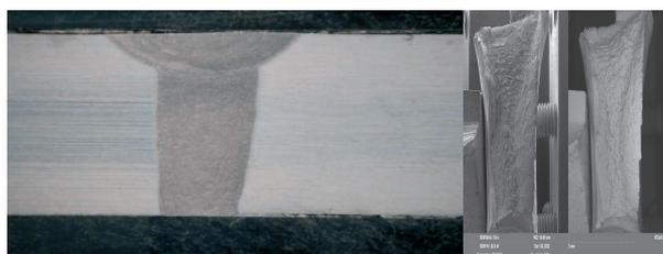
Рис. 5. Макроструктура и излом образцов, полученных ЭЛС
