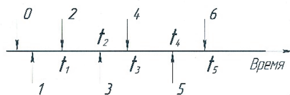
Рис. 1. Диаграмма СВС-компактирования: 1 – подача теплового импульса; 2 – зажигание; 3 – конец горения; 4 – прессование; 5 – сброс давления; 6 – выгрузка заготовки
