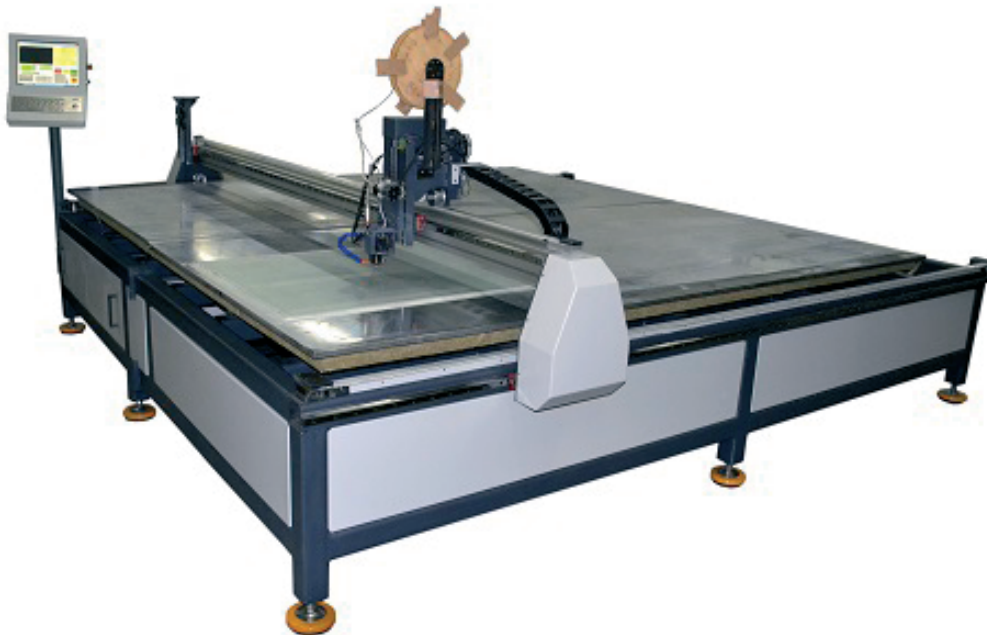
Рис. 6. Опытный образец 3D принтера (ФГУП «НПО «Техномаш»)
