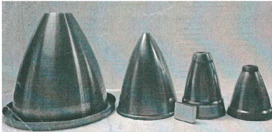
Рис. 13. Полуфабрикаты сопел КС после ротационной вытяжки
