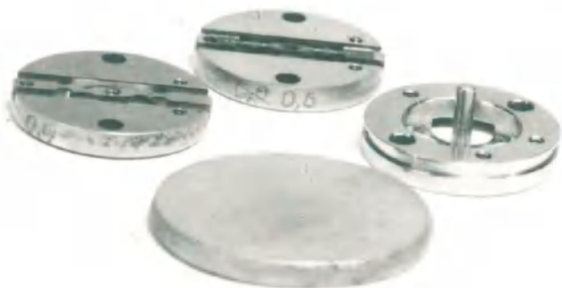
Рис. 2. Сферодиамическая штамповка подложки чувствительного элемента и чувствительные элементы датчиков давления с тензосхемой из золота
