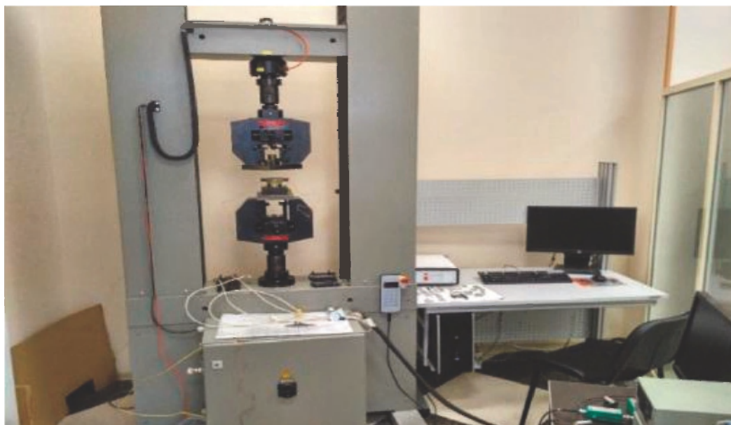
Рис. 24. Прочностные испытания клеевых соединений
