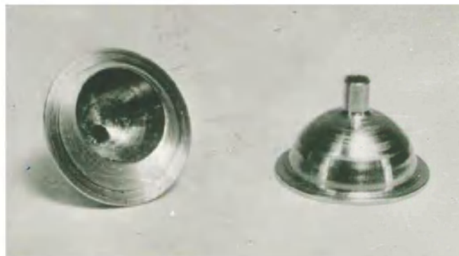
Рис. 3. Сферодиамическая штамповка корпусов датчиков момента инерции
