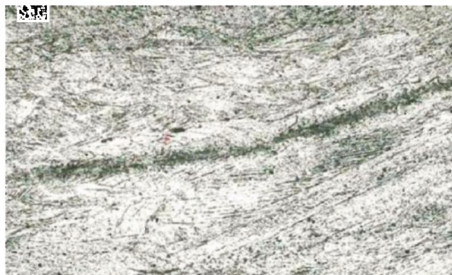
Рис. 8. Структура металла сферодинамической штамповки ложемента державки для ручной шлифовки алмазов
