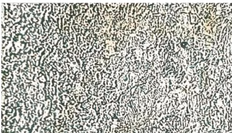
Рис. 4. Структура металла подложки чувствительного элемента в зоне напыления тензосхемы
