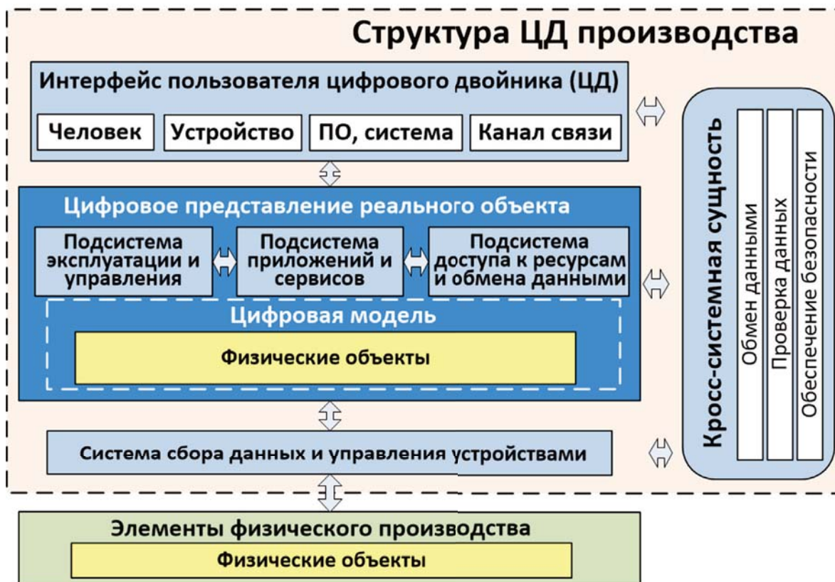
Рис. 3 Структурная схема цифрового двойника производственной системы
