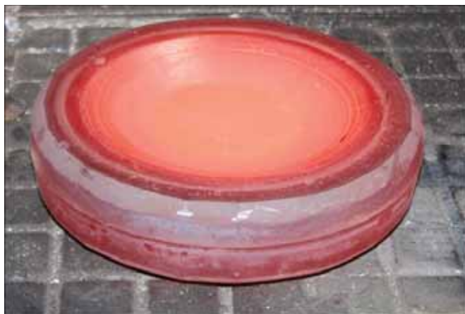
Рис. 4 – Поковка корпуса турбины после второго перехода штамповки
