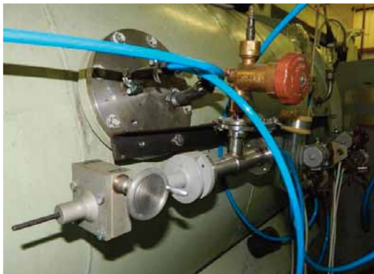
Рис. 3 – Устройство для нанесения КСМ покрытия
