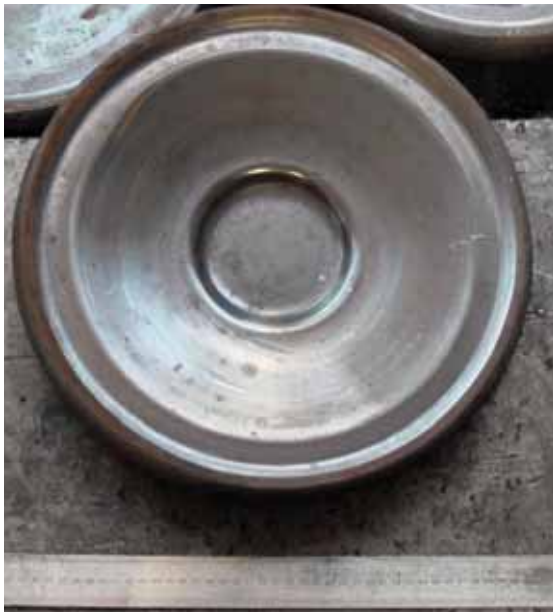
Рис. 1 – Поковка корпуса турбины
