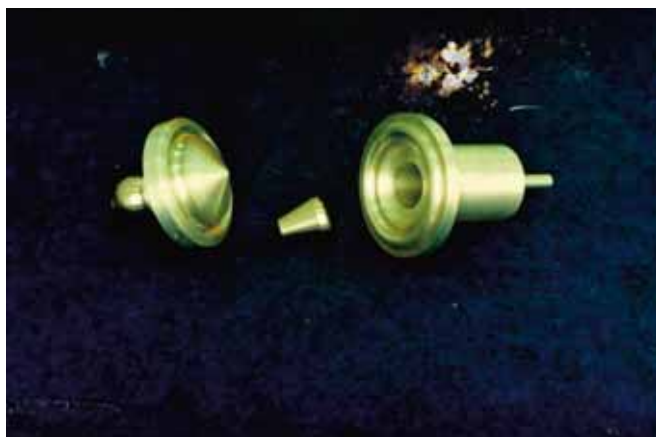
Рис.2 – Сферодинамическая штамповая оснастка
