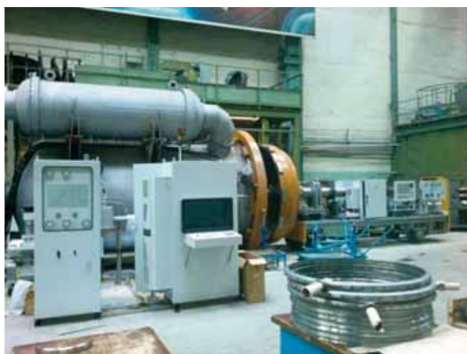
Рис. 1 – Опытный образец установки ЭКУ-2П в сборочном цехе завода-изготовителя
