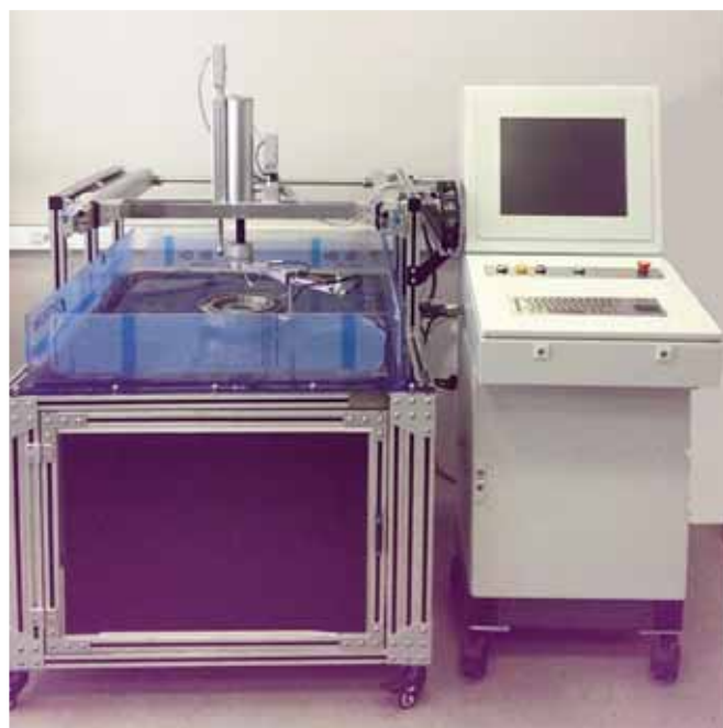
Рис. 1 – Общий вид автоматизированной установки контроля пайки
