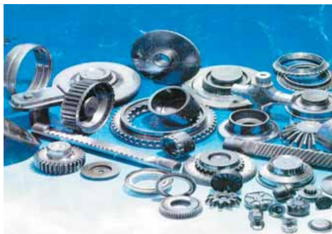
Рис. 9 – Представители нового поколения деталей сложной формы, изготавливаемых по технологии сферодинамического аддитивного формообразования
