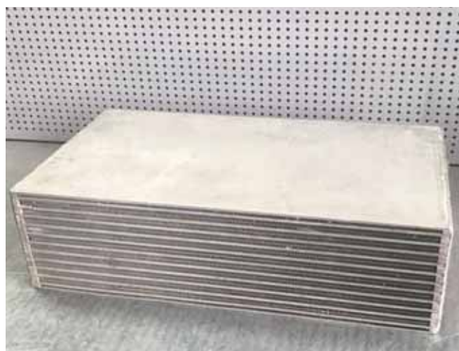
Рис.2 – Внешний вид камеры установки УВП-1 (а) и паяного опытного образца теплообменника (б)
