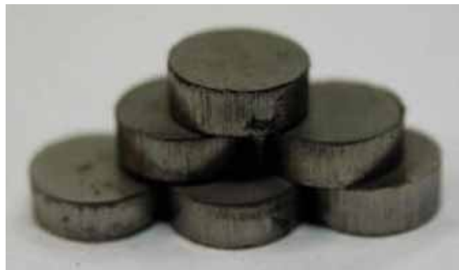
Рис. 3 – Внешний вид опытной партии таблеток компактного модификатора карбонитридом титана ( Ti_xC_yN_z )
