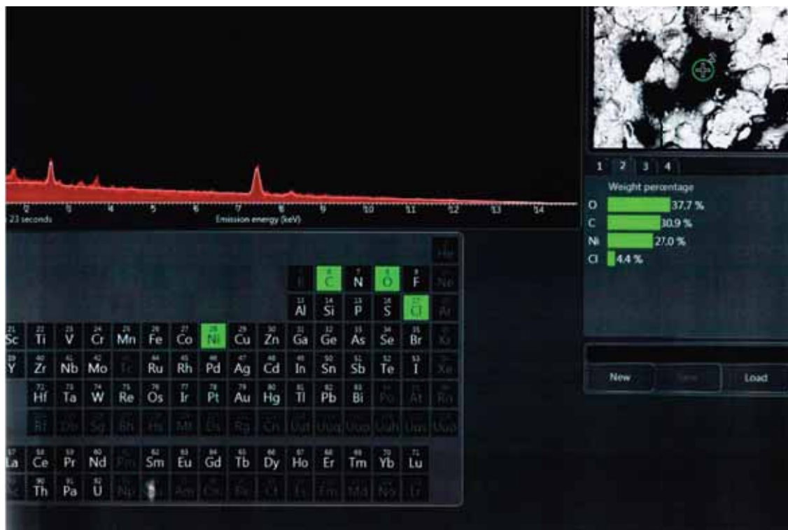
Рис. 6 – Химсостав электрохимического металлоалмазного покрытия толщиной 10 мкм сплава ВТ5-1 в темной зоне 2
