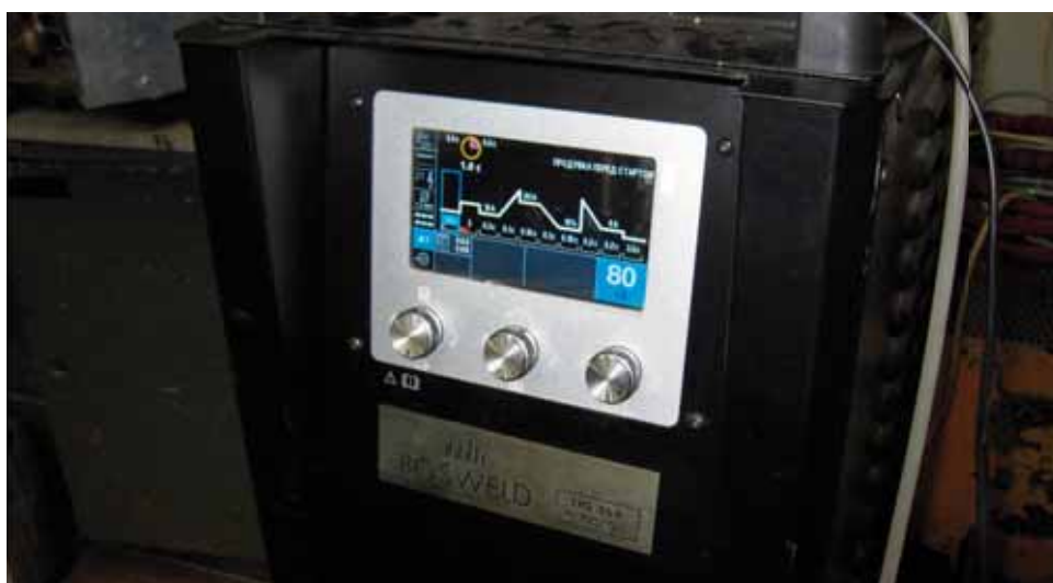
Рис. – Панель управления сварочного источника
