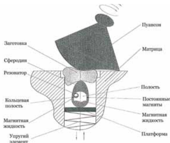
Рис.3 – Принципиальная схема реализации сферодинамического аддитивного формообразования
