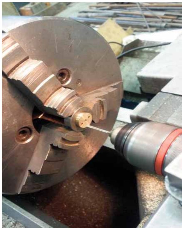
Рис. 4 – Внешний вид универсального узла для сверления наклонных отверстий в деталях сварочной головки, размещённой на токарном станке модели SV18PA
