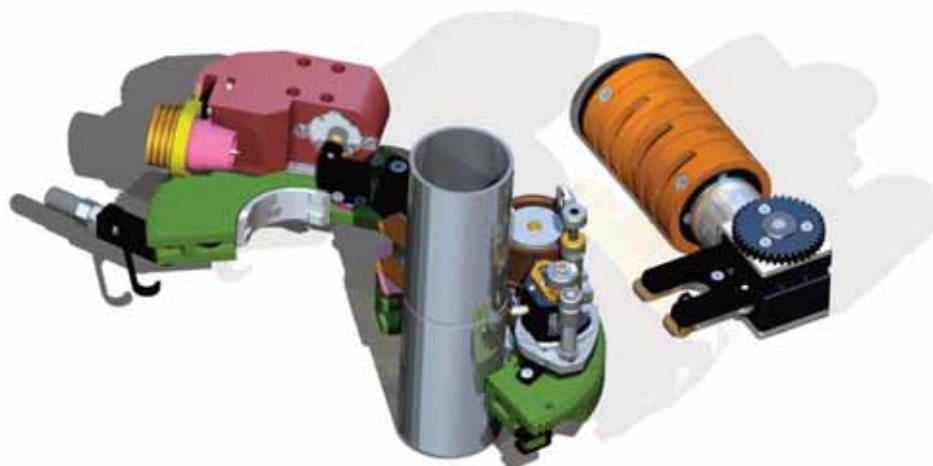
Рис. 3 – 3D модель ГНС 25-45. Замыкание на участке трубопровода
