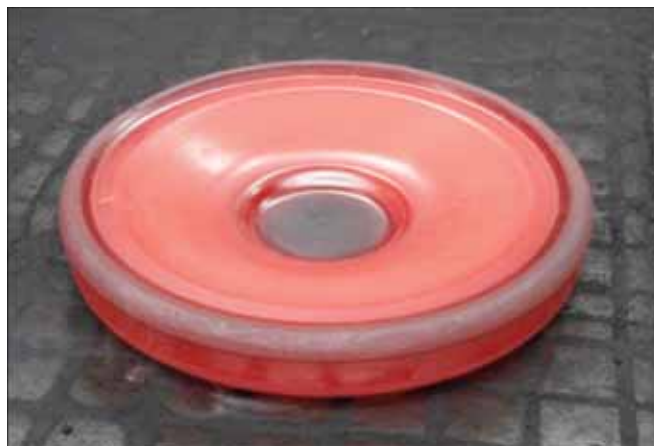
Рис. 5 – Поковка корпуса турбины после третьего (окончательного) перехода штамповки
