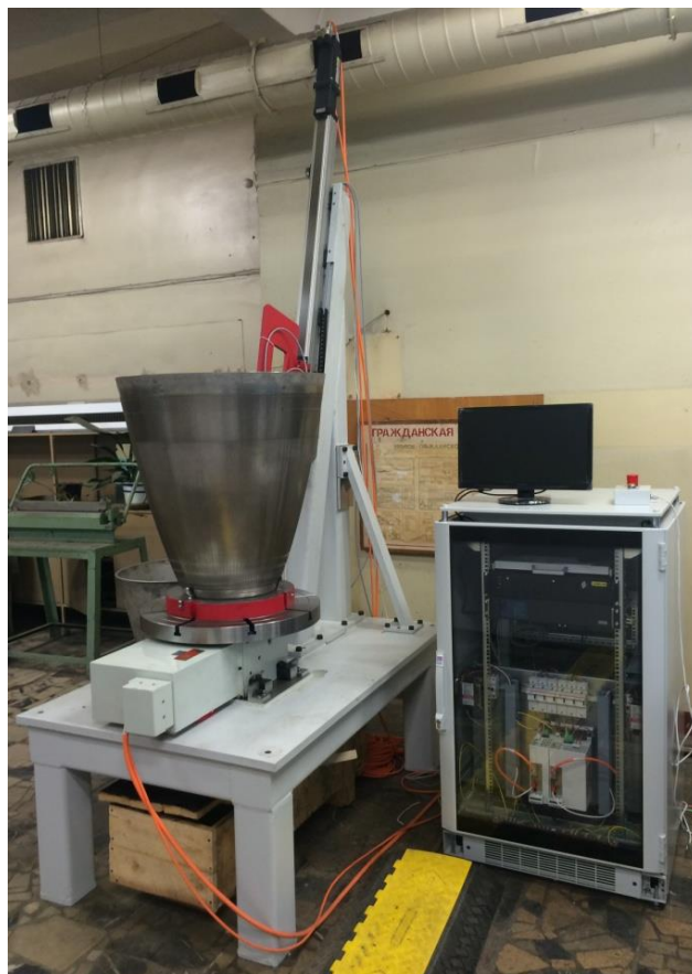
Рис. 2 – Установка для автоматизированного оптического контроля толщины стенок сопел и КС ЖРД после РВ ТМКБ.6.25.165.00.00.000
