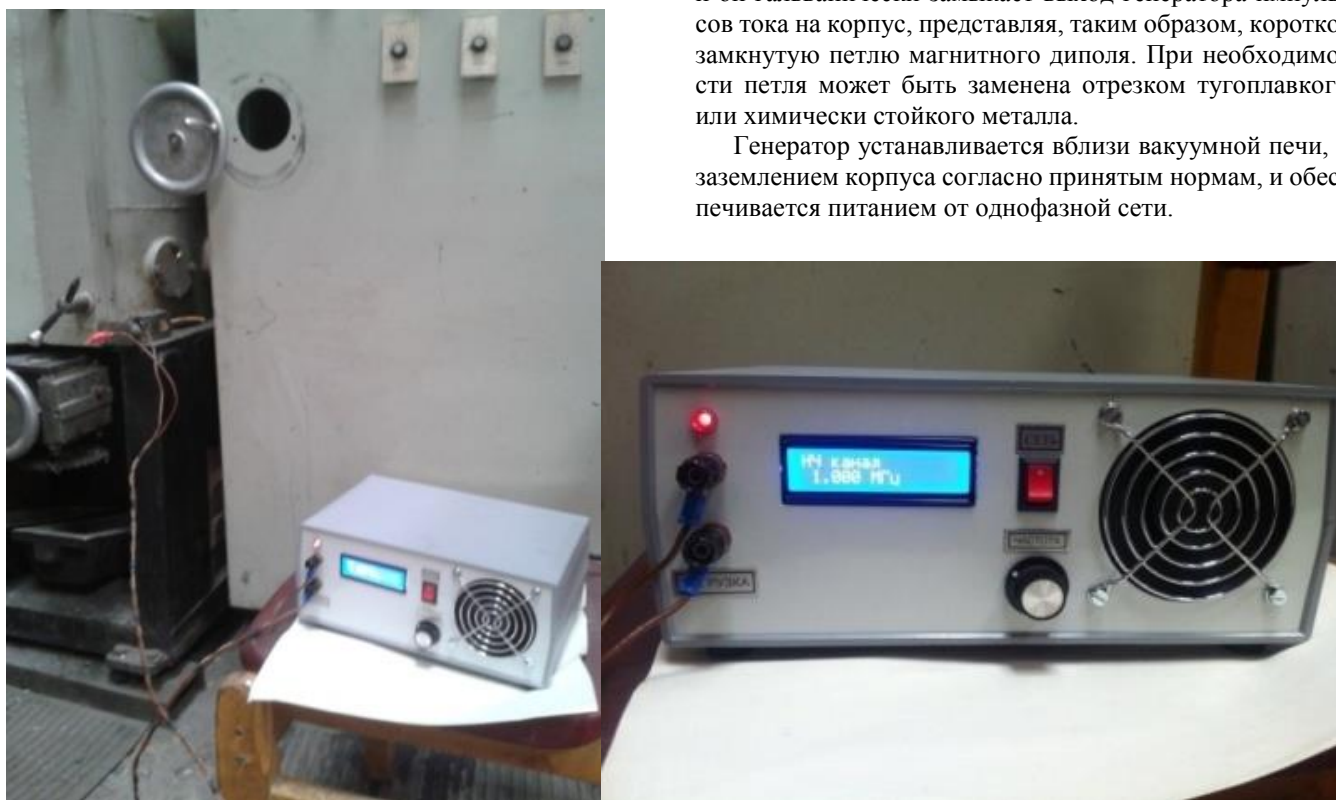
Рис. 1 – Ультразвуковой генератор УЗГ 1-0,01/950 в работе с подключением к вакуумной индукционной установке «Кристаллизатор-105» во время вакуумной плавки
