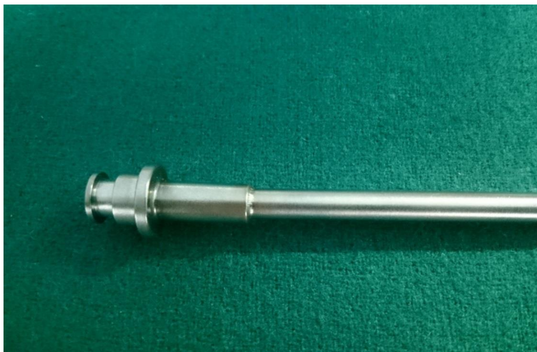
Рис. 2 – Внешний вид паяного макетного образца из стали 12X18H10T
