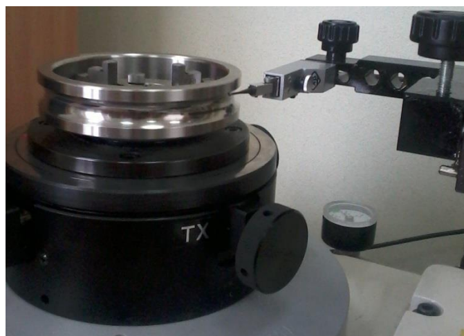
Рис. 5 – Получение «слепок» дорожки качения наружного кольца подшипника (а) и фото кругломера Serfcom 1800D-12 (б)
