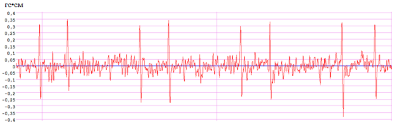
Рис. 4 – Увеличенный график дефектов (момент сначала возрастает, потом падает. Тип дефекта – выступ)
