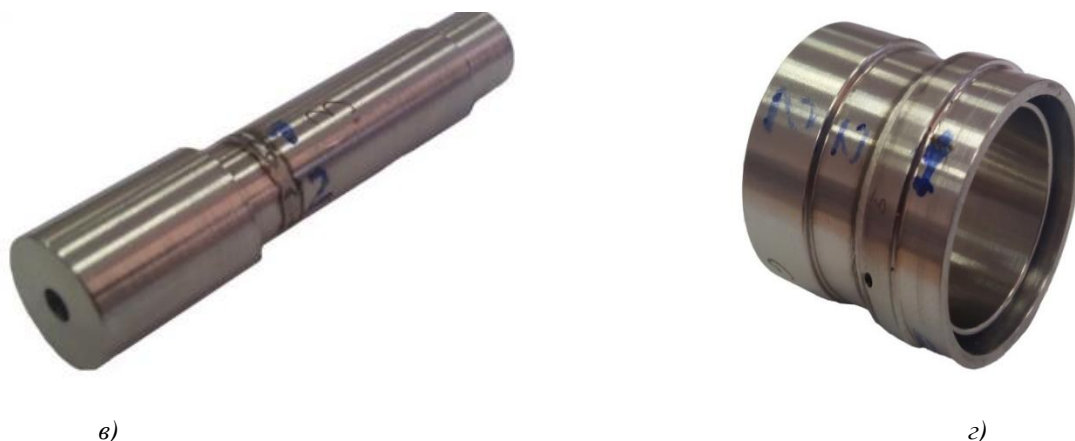
Рис. 2 – Форсунки ЖРД, изготовленные с применением лазерной сварки: а) форсунка РД1; б) форсунка ГЖ1; в) форсунка РД2; г) форсунка ГЖ2
