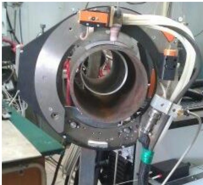
Рис. 2 – Сварочная головка с подачей присадочной проволоки для орбитальной сварки в монтажных условиях трубопроводов из алюминиевых сплавов диаметром от 160 до 190 мм
