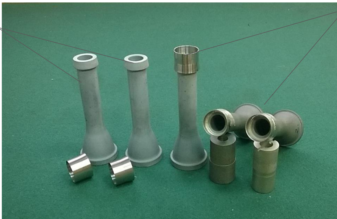
Рис. 1 – Внешний вид образцов до и после пайки
