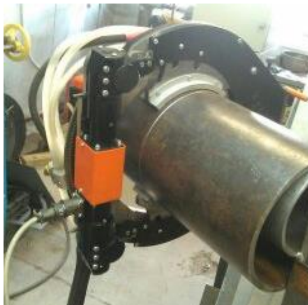
Рис. 2 – Сварочная головка с подачей присадочной проволоки для орбитальной сварки в монтажных условиях трубопроводов из алюминиевых сплавов диаметром от 160 до 190 мм
