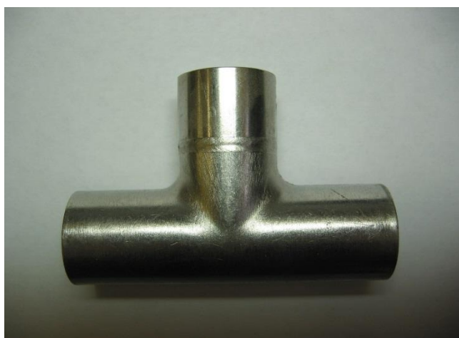
Рис. 7 – Образец сварного шва, выполненного сварочной головкой типа ГСК
