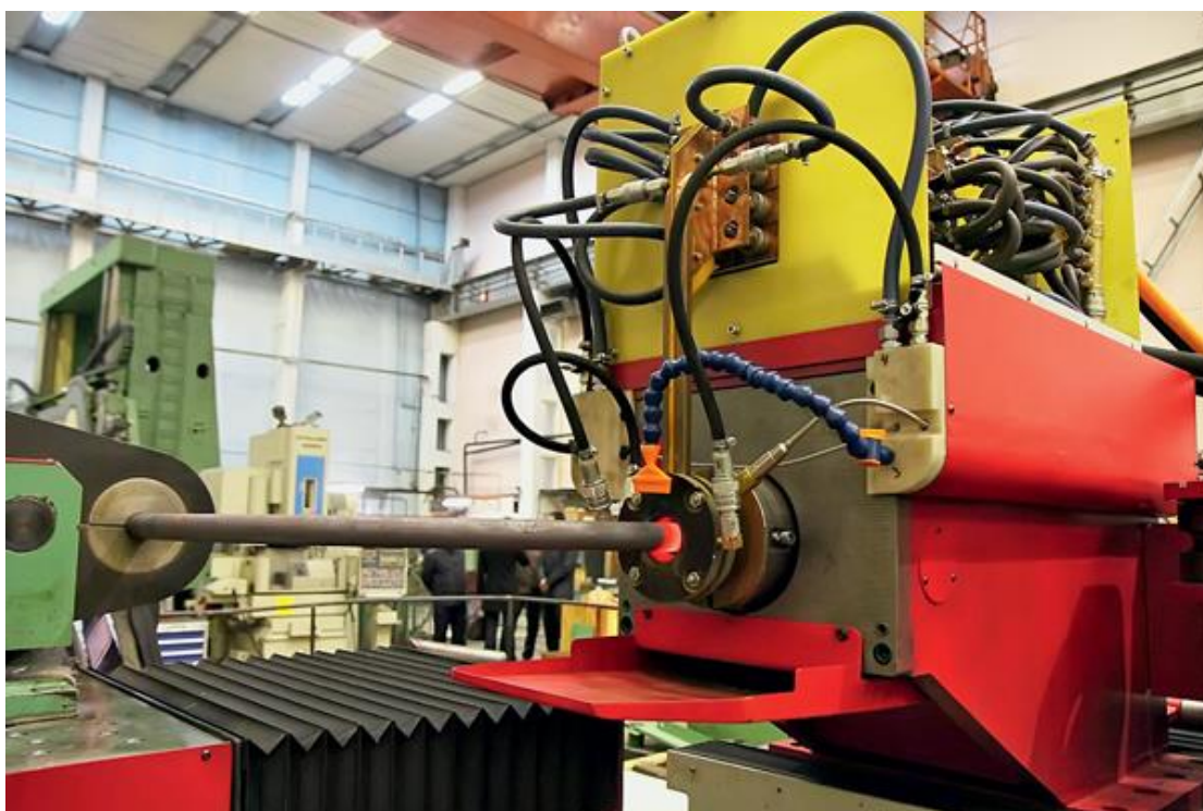
Рис. 2 – Гибка труб с узкозональным индукционным нагревом на станке СГИН-120. В индукторе видна зона нагрева (воздушно-водяное охлаждение отключено для съемки)
